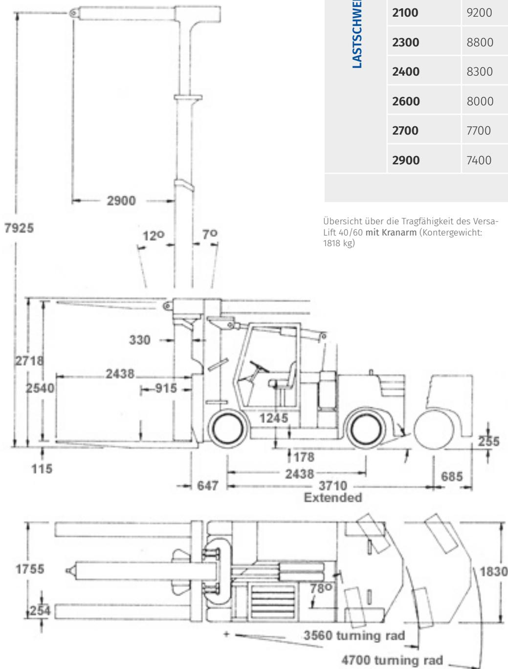
Übersicht über die Tragfähigkeit des Versa-Lift 40/60 mit Kranarm (Kontergewicht: 1818 kg)
