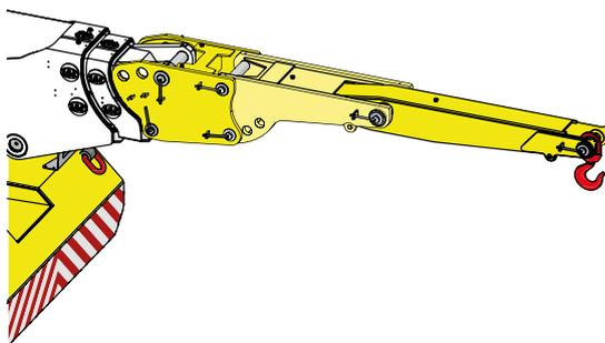
Schwenkbarer Jib 22 t – Länge 1,5 m (vielfach verstellbar)
