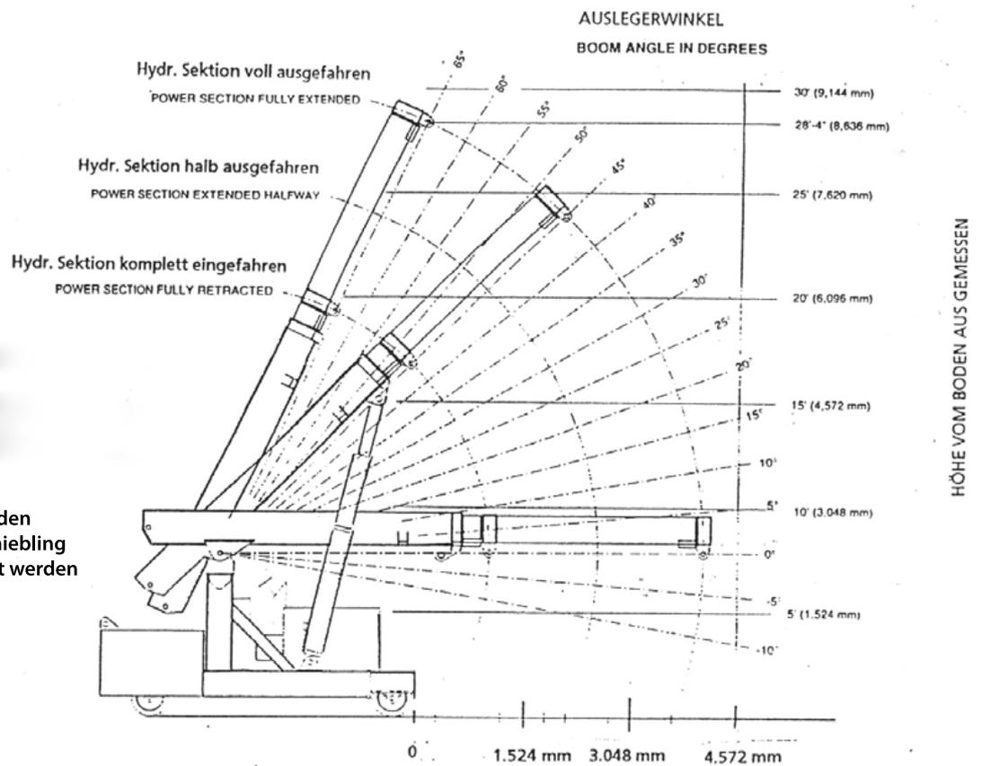
Die Reichweite kann durch den integrierten, manuellen Schiebling um zusätzliche 3,0 m erhöht werden
