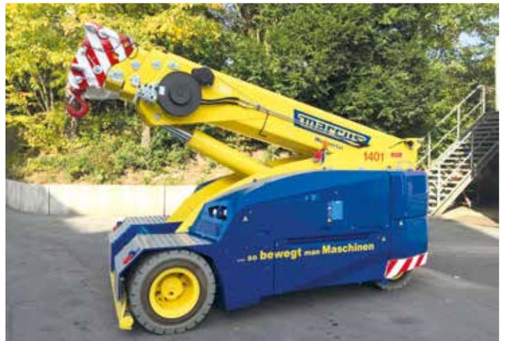
» Marcus V-Kart Spezialkran zum Handling von Maschinen und Anlagen-teilen unter beengten Verhältnissen. «
