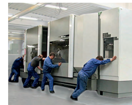
Luftkissentransporte Schweres leicht gemacht
